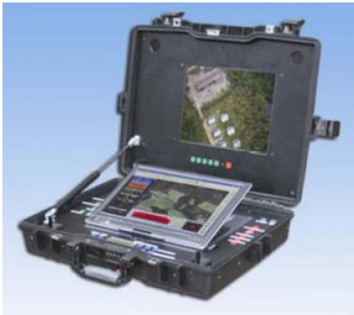
29. ábra az „Irkut-10” RPA földi irányító állomása
