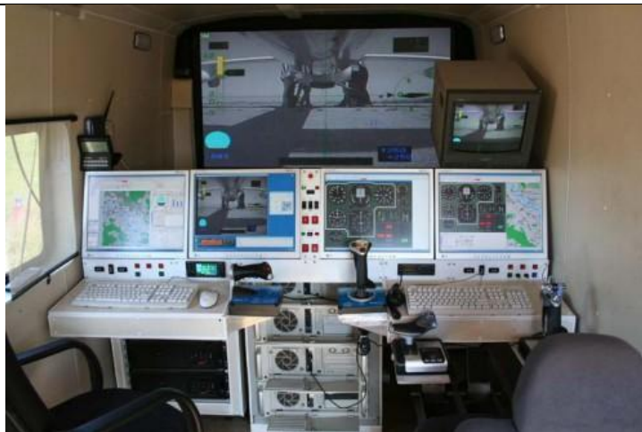
27. ábra az „Irkut-850” RPA földi irányító állomása
