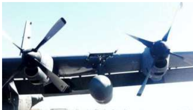
1. ábra Ütközés a levegőben: RQ-7 Shadow UAV által okozt sérülés egy C-130 Herculesen 4
