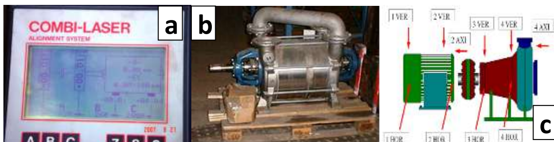
12. ábra A COMBI LASER műszeren kijelzett információk [11] (a), Az esettanulmányban szereplő vízgyűrűs SIHI LPH típusú vákuumszivattyú képe (b) [8] A motor-szivattyú egység mérési azonosítóinak felépítése (c)
