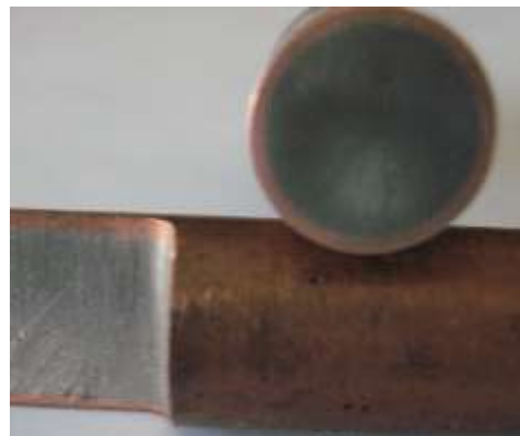
15. ábra A TI-Shield™ anyag működési elve és a magyar réz-acél anyagminta
