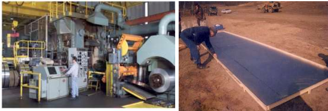
4. ábra A hengerléssel és a robbantásos plattírozás berendezései
