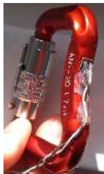
9. ábra Karabinerre felragasztott nyúlásmérő bélyeg és forrasztási terminál
