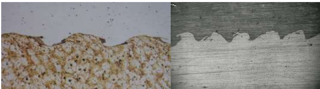
6. ábra Robbantással plattírozott alumínium-réz és acél-alumínium anyag kötési zónája (x50)
