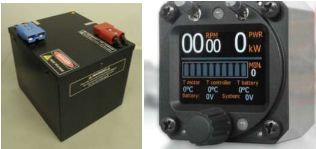
11. kép. A Pipistrel Taurus Electro G2 egyik akkumulátora és az ESYS-MAN 16 17
