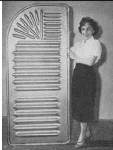
11. ábra Alumínium ötvözet, hullám-alakzatra robbantott repülőgép panel 22
