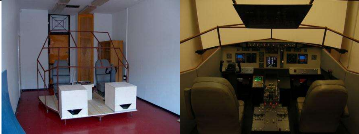
1. ábra balra: a szimulátor, még építés közben, jobbra: az elkészült szimulátor [1]
