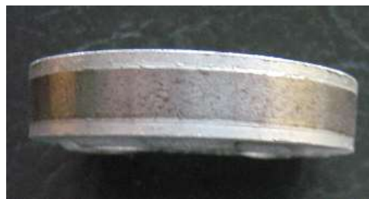
19. ábra Alumínium-acél közdarab alkalmazási példája és a magyar acél-alumínium illetve alumínium-acél-alumínium anyagminták
