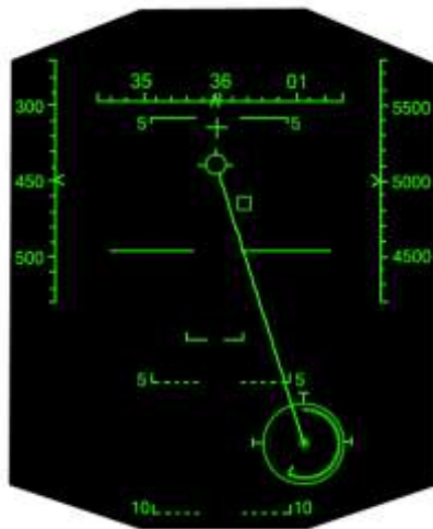
4. ábra. F-15E HUD CCIP üzemmódjának szimbólumai (forrás: http://www.ausairpower.net/Profile-F-15A-D.html )
