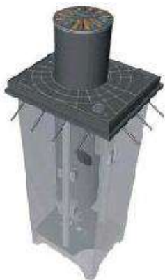
5. ábra Hidraulikusan kiemelkedő oszlopok szerkezeti kialakítása 9
