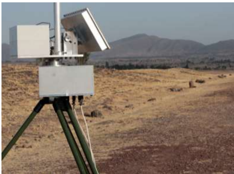
9. ábra A földi vezérlőállomás kommunikációs egysége
