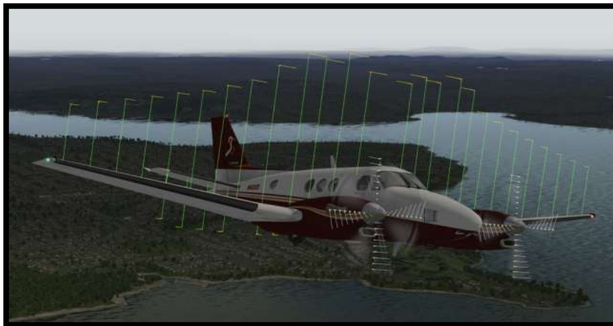
4. ábra X-Plane képernyőkép az egyes profilokon számított erőkkel 5
