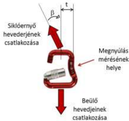
16. ábra Karabinerre ható erők változása
