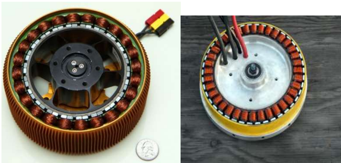
7. kép Belső- és külső mágneses gyűrűt alkalmazó radiális motor 10 11
