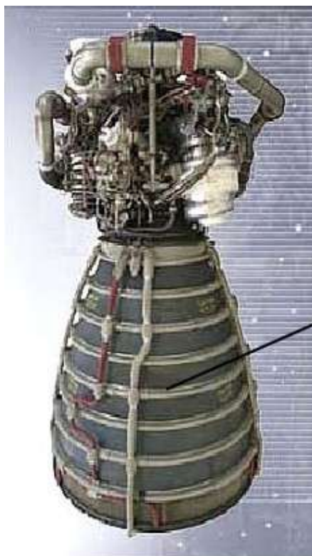
9. ábra Rakétahajtómű robbantással kialakított harangja 20
