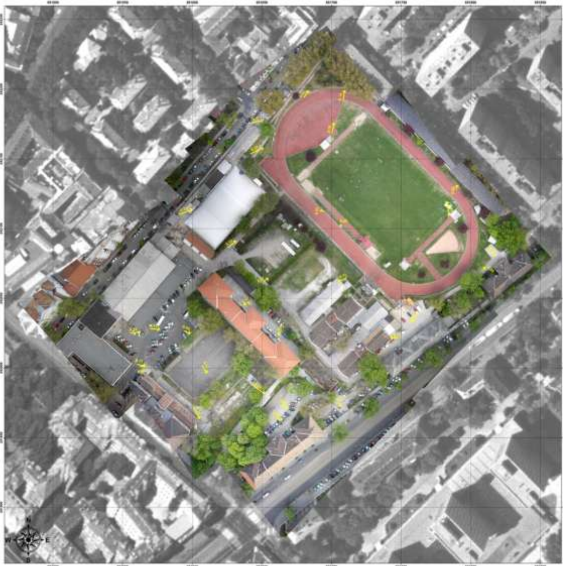
5. ábra A tesztrepülés felvételeinek ortofotó térképe az ellenőrző mérések eredményeivel
