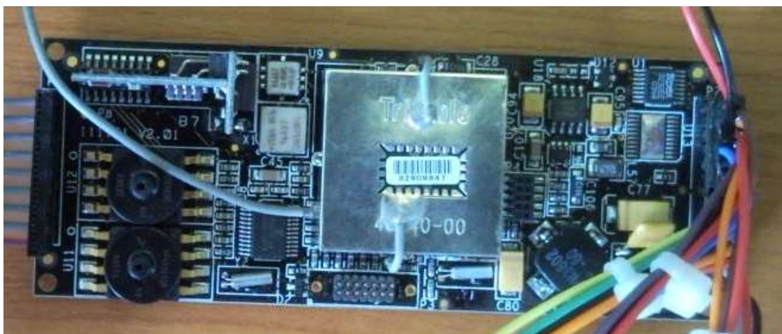
5. kép Az MP2028 alaplapja két nyomásmérő érzékelővel és a GPS vevővel 9
