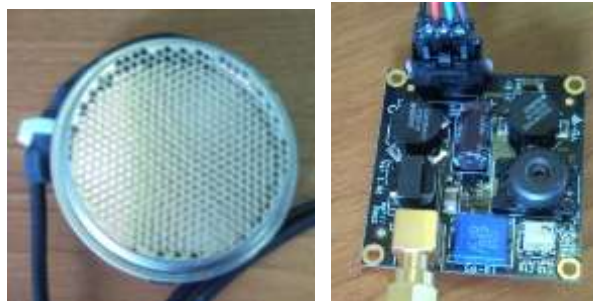
4. kép Az akusztikus magasságmérő antennája és adó/vevő berendezése 11
