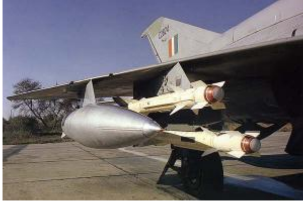
3. ábra A P-62-IIM indítóberendezés a belső szárnyalatti tartóra függesztve egy indiai MiG-21BIS-en [8]
