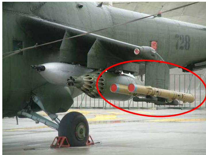
15. ábra 9M114 típusú „STURM” irányítható rakéta
