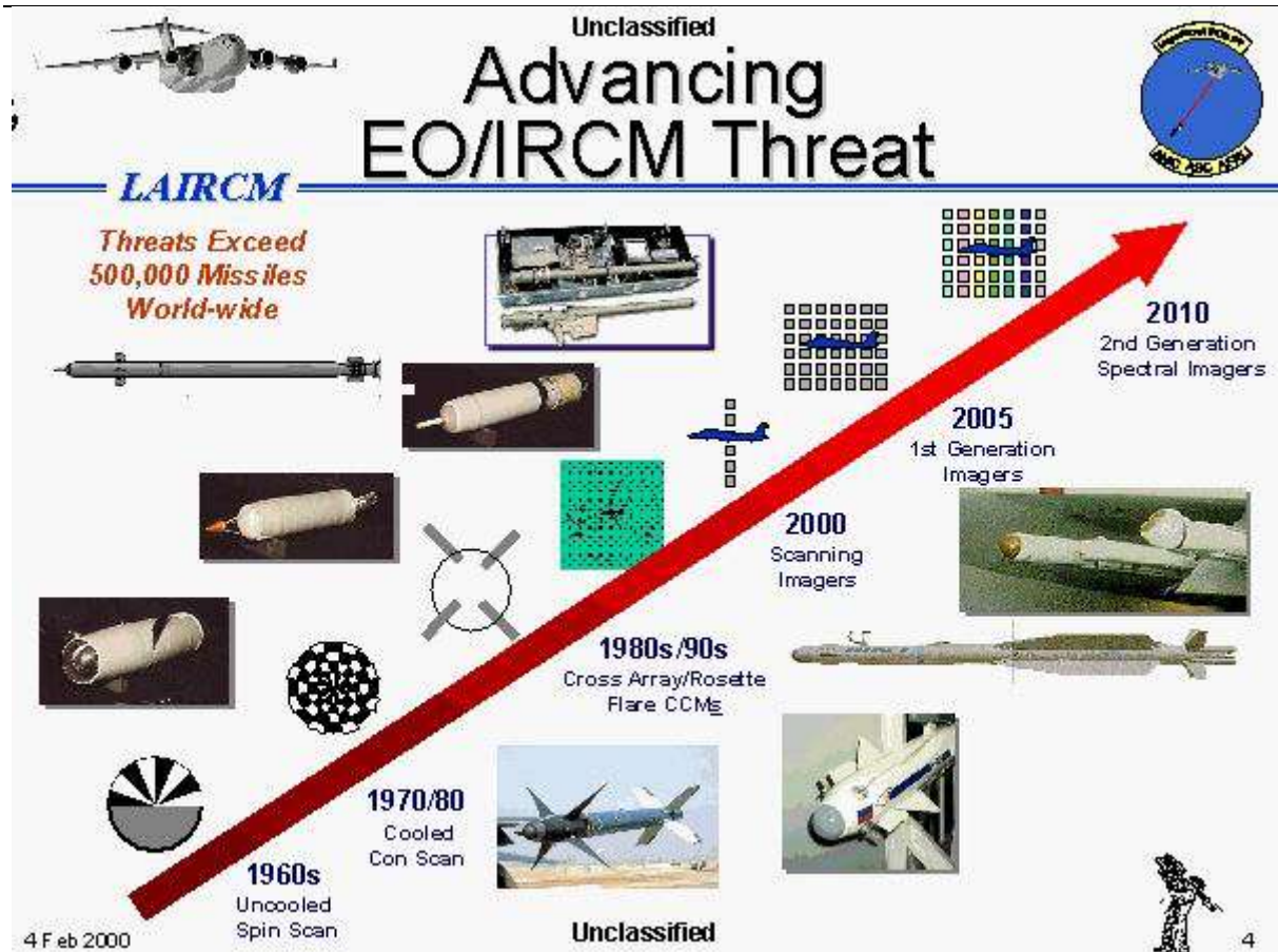
1. ábra Az infravörös önirányítású rakéták fejlődési iránya [3]
