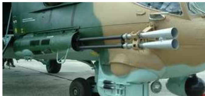
11. ábra A GS-2-30 gépágyú
