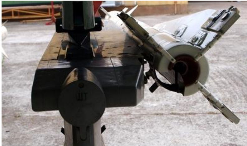
9. ábra A tartó hátulján lévő fedél [10]
