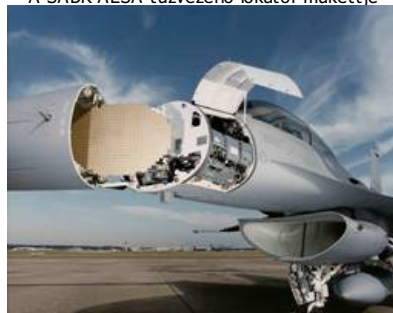
A Raytheon cég RACR AESA tűzvezérlő lokátora az USAF F-16 repülőgépébe beépítve
