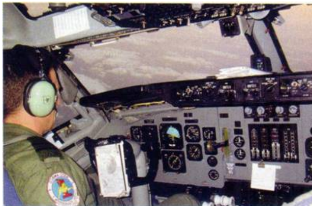
Az NMT program alapján módosított E-3A AWACS pilótafülkéjének mellő műszerfala.
