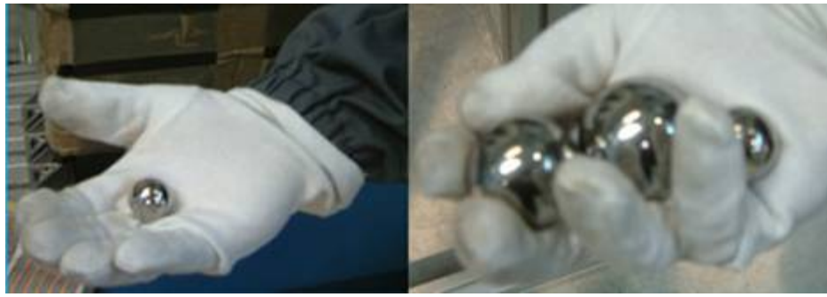
10. ábra Jégeső szemeket szimuláló acélgolyók
