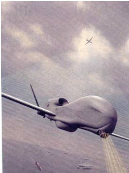
A BAMS UAV repülőeszköz 360o-os körforgást biztosító aktív elektronikus pásztázást alkalmazó antennarendszerrel (AESA) ellátott lokátora a törzs alatti radar domban, a toronyra szerelt
