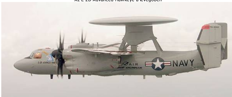
Az E-2D Advanced Hawkeye oldalnézetben. A repülőgép új, 360°-ban pásztázó ESA lokátora biztosítja a célkiválasztást.
