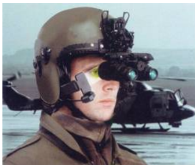
Az UK Mk 10 repülősisakra felszerelt Q-Sight rendszer a Nightbird NVG készlettel
