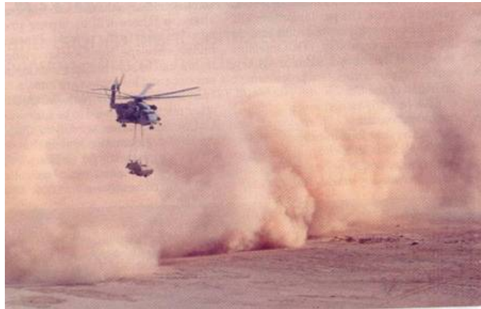
A haderőnemek a Yuma (Ariz.) melletti por- és homoksvatagon végzik a lecsökkent látási körülmények közötti üzemeltetést biztosító megoldások értékelését. A képen egy Sikorsky CH-53E helikopter a forgószárnyával felvert homokkal "brownout" viszonyokat hoz létre.
