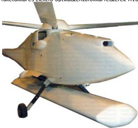
Az A160T helikopterre felszerelt Forester radar
