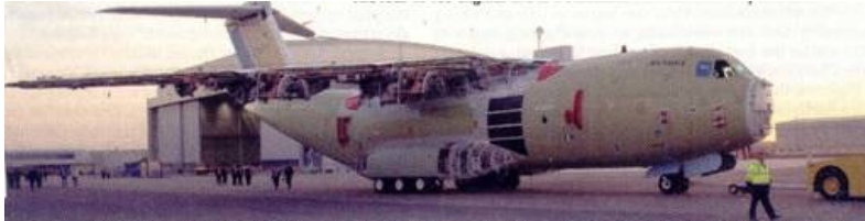
Az első A400M prototípus összeszerelése befejeződött, de a négy TP400 hajtómű csak később kerül beépítésre
