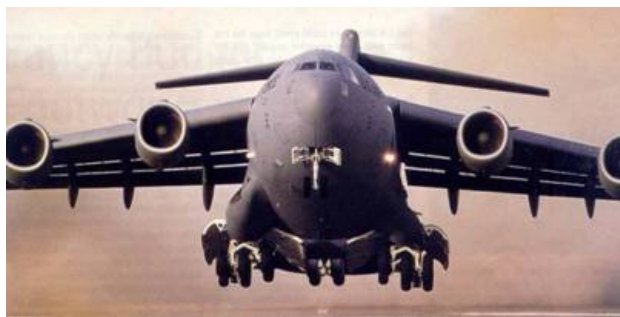
A STOL kategóriájú C-17B új középső kettős futóművel, nagyobb tolóerejű hajtóművekkel, valamint két részből álló fékszárnyakkal lesz ellátva.
