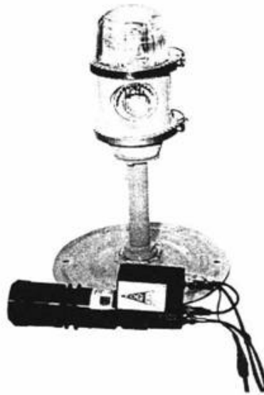
2. ábra. A ködszem érzékelő és fényforrása
