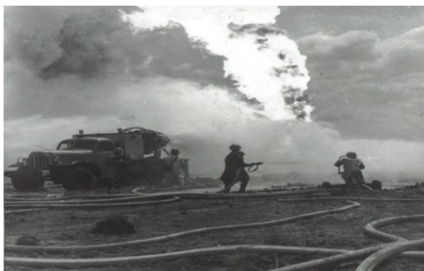
4. ábra. Turbóreaktív oltógép munka közben
