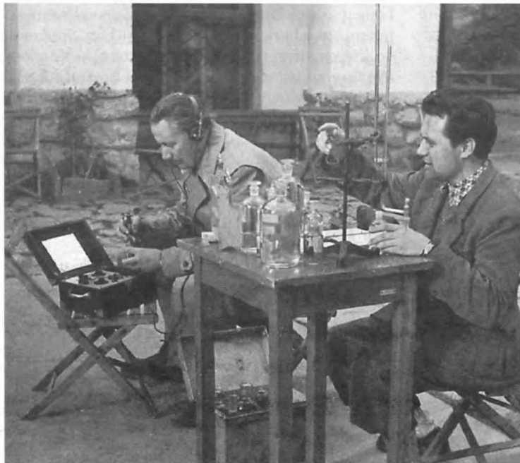
A függőleges szivárgási sebesség meghatározása a Baradla-barlangot fedő mészkőben. Kessler Hubert (baloldalon) a 100 mm-es esőztetéssel folytatott kísérlet vízmintáinak ellenállásmérését végzi munkatársával (1955)
