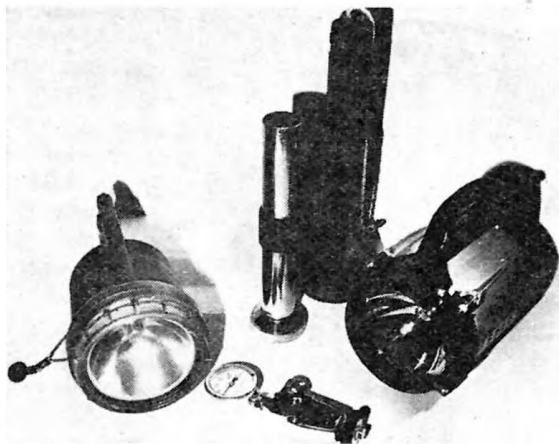
Különböző vízmentes lámpák: Vega, Aqua Lux, Tana, Technisub Sole, elől pedig egy ellenőrző manométer
