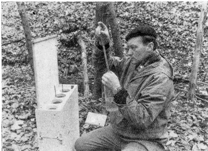
Terepen történő kolorimetralás kélliteres üveghengerekkel.
