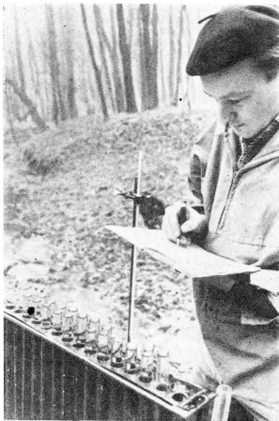
Kolorimetraló kémcsövek használata terepen.
