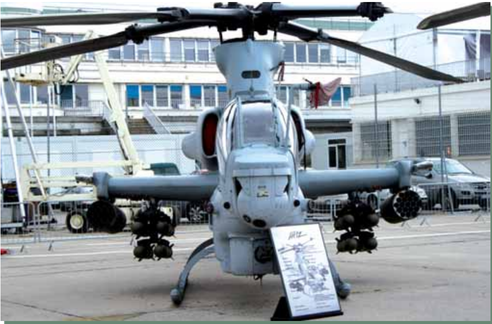
TISZTELET PARANCSOL A BELL AH-1Z VIPER TÍPUSÚ KÉTHAJTÓMŰVES TÁMADÓHELIKOPTER, AMELYNEK ELŐDJÉT, AZ AH-1W SUPERCOBRÁT AZ AMERIKAI HADITENGERÉRSZET ELITEGYSÉGE (MARINE CORPS) FELADATAIRA SZABVA ÉS IGÉNYEI SZERINT FEJLESZTETTÉK KI. A KESKENY TÖRZSET STABILIZÁLÓ SZÁRNYCSONKOK JÓL LÁTHATÓAN TEHERVISELŐ CÉLT IS SZOLGÁLNAK
