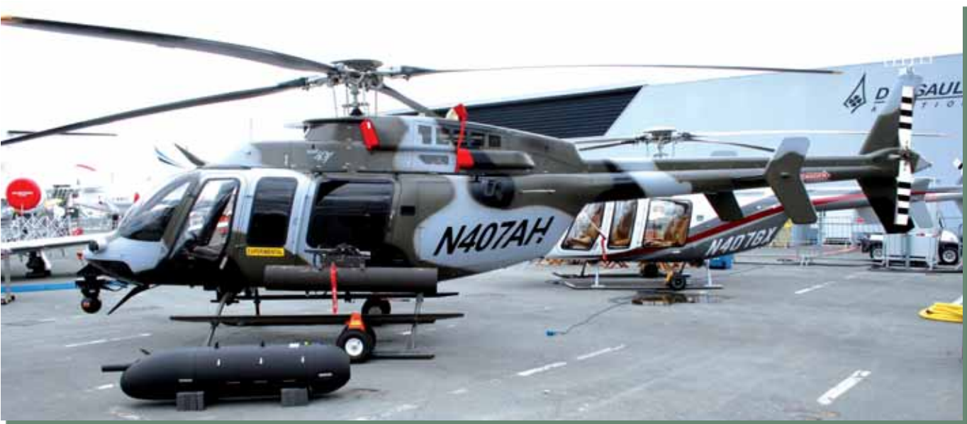
A Bell 407AH jobb oldalán egy Dillon M-134T típusú távirányítású, 7,62-es géppuska, a bal oldalán pedig (a képen) a csüszőtálpal fölé szerelve egy M260 típusú, hétlövéses gránátvetőt látható
