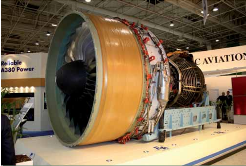
A HAJTÓMŰ MÉRETE HATALMAS: 4,74 M HOSSZÚ A KIÖMLŐNYÍLÁSIG; BRUTTÓ ÁTMÉRŐJE 3,16 MÉTER, TURBINALÁPÁJAINAK FORGÁSI ÁTMÉRŐJE 2,95 M; KENŐANYAGOK NÉLKÜLI SZÁRAZ SÚLYA 6700 KG; EGYENKÉNTI TOLÓEREJE PEDIG ELKÉPESZTŐ: 363 kN
