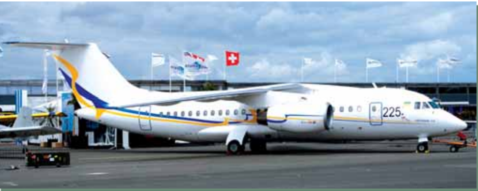
AZ AN–148-AS 5 M-REL MEGNÖVELT TÖRZSHOSSZÚ VÁLTOZATA AN–158 TÍPUSNÉVEN SZEMÉLYESEN IS BEMUTATKOZOTT. MEGGYŐZŐ VOLT A REPÜLŐGÉP RENDKÍVÜLI FORDULÉKONYSÁGA ÉS DINAMIKÁJA. MEGLEHETŐSEN CSENDES, 64 kN TOLÓERŐT BIZTOSÍTÓ, D-436 TÍPUSÚ HAJTÓMŰVE AZ IVCSENKO PROGRESS ÉS A MOTOR SICH OROSZ TERVEZŐ IRODÁK KÖZÖS FEJLESZTÉSE
