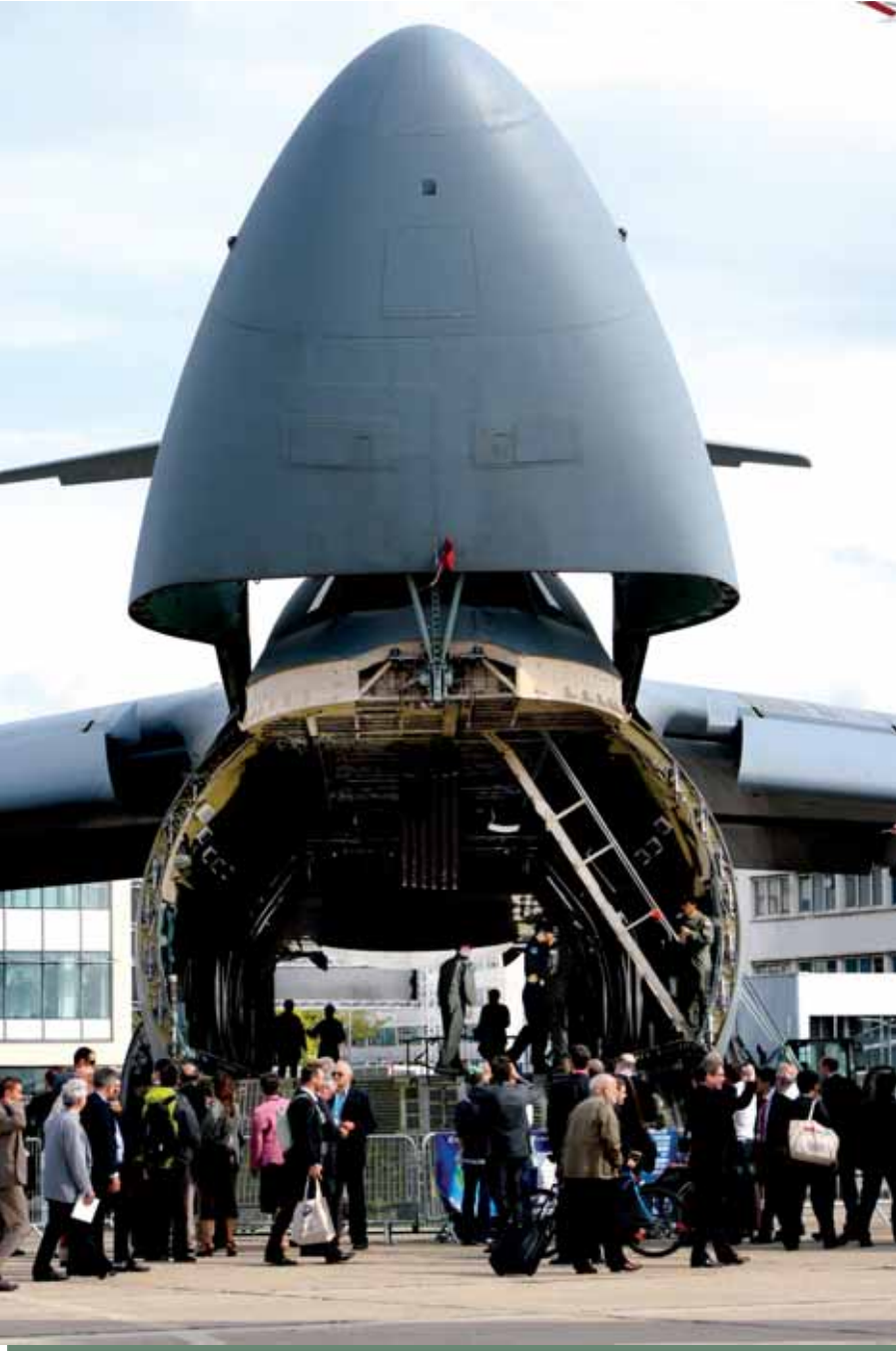
Az amerikai légierő korszerűsített Lockheed C-5-öse, amint árufogadásra történő felkészülést imitál. Ennek a Super Galaxy-nak új repülési rendszere és új típusú hajtóművei miatt a típusjele C-5M-re módosult (oldalszáma: 86-0025). Ki hinné, hogy a típus C-5A alapvariánsai már Vietnámban is szolgáltak...
