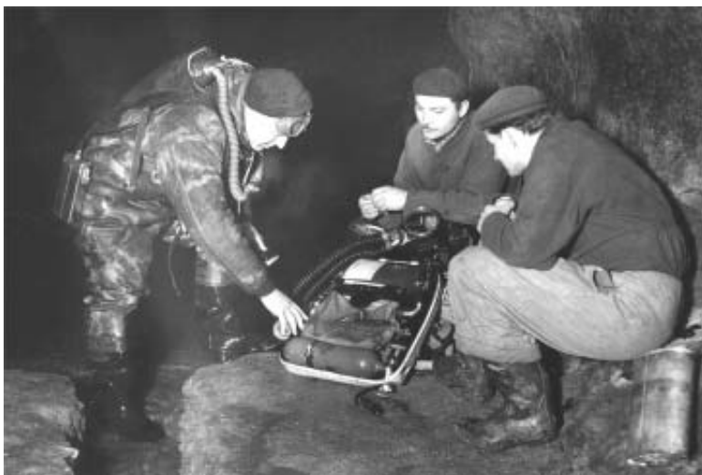
3. kép: A búvárkészülékek próbája. A földön CH250 típusú mentőkészülék, valamint Rozložník a Medi-Nixe búvárkészülékkel. Gombaszög, 1957.
