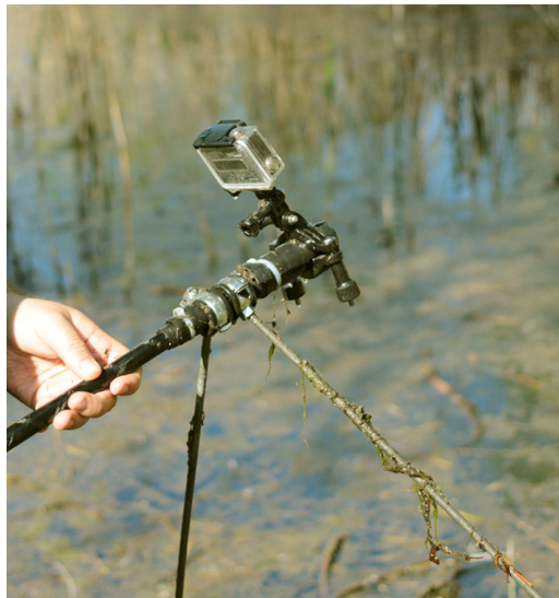
1. ábra. Lábakkal ellátott teleszkópos nyélre erősített videokamera
