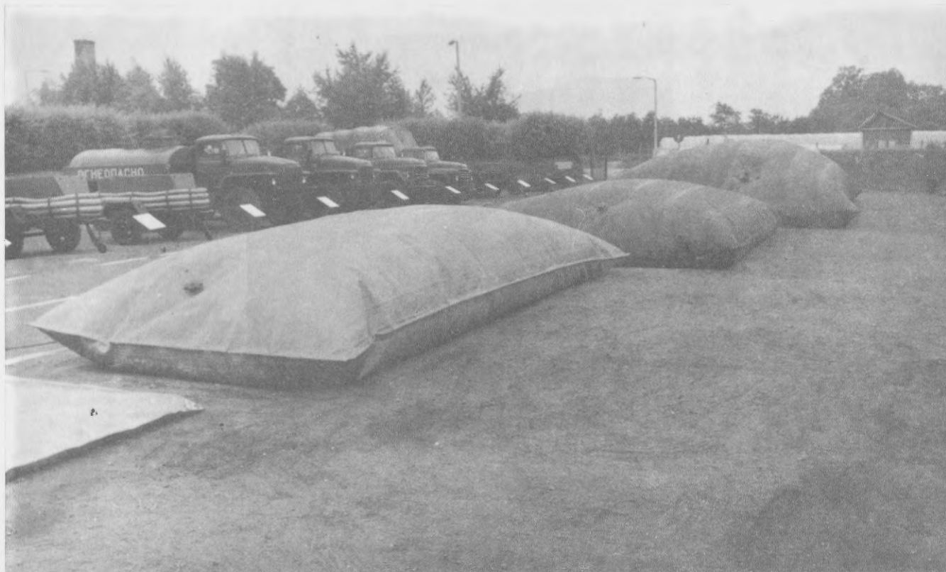
3.sz.kép: Előtérben az MR típusú hajlékony úze. tartályok különböző méretekben.
