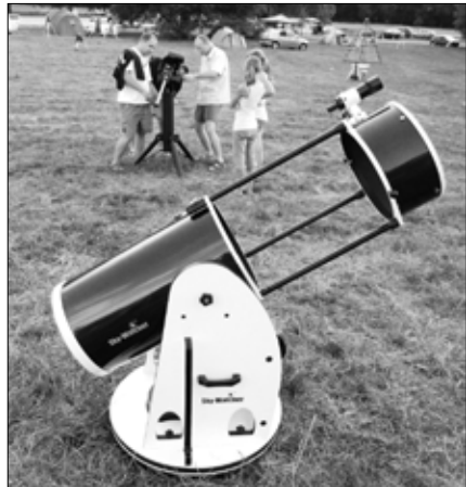
Főműszerünk, a 355/1650-es Dobson-távcső (a fotó már a tarjáni észlelőretn készült)
