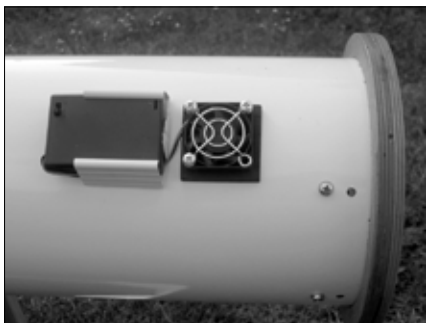
A tubus főtükör felőli vége a tükrök felületére fújó ventilátorral. A levegő határréteg lefúvása jelentős képjavulást eredményez. A 40 mm-es 12 voltos ventilátor hatékonyan fújja le a főtükör felületéről a képminőséget jelentősen rontó levegő határréteget. Három ceruzaelem működteti zaj- és rezgésmentesen
