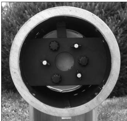
A főtükörtartó „alulnézetben”. Jól látható, hogy milyen sok hely maradt a főtükör és a tubus belső fala között
