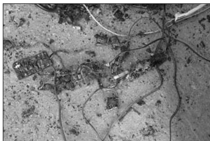
A „bűnös” elosztó és a két tápegység maradványai
