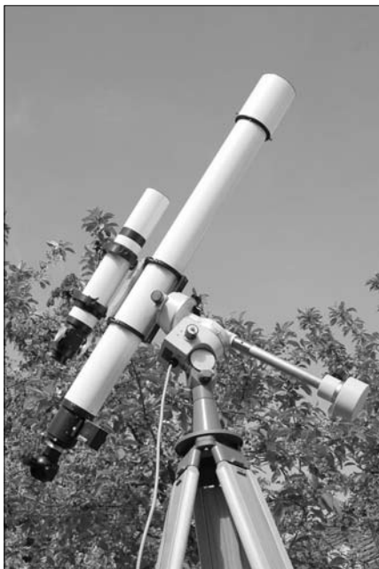
A 80/1200-as AS objektív és az 50/540-es C objektív tubusba szerelve, Zeiss IB mechanikán
