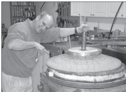
Készül a 81 cm-es óriástükör. Figyeljük meg a tűkór könnyített szerkezetét, valamint az eredetileg is a görbülethez illeszkedő hátoldalt
