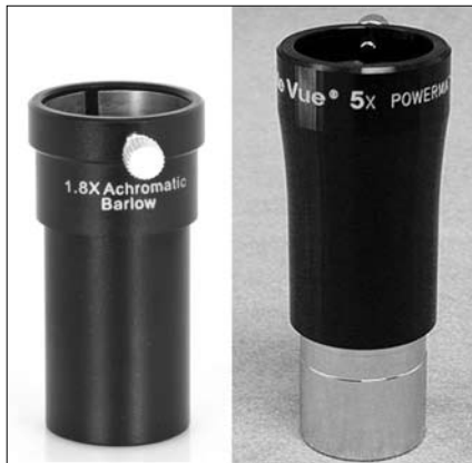
Egy hagyományos Barlow-lencse és egy Powermate. Kinézetre és esetenként a fókusznyújtás mértékére nézve is hasonlóak lehetnek, de míg a Barlow lencse negatív nyújtótágra épül, a Powermate telecentrikus rendszer
