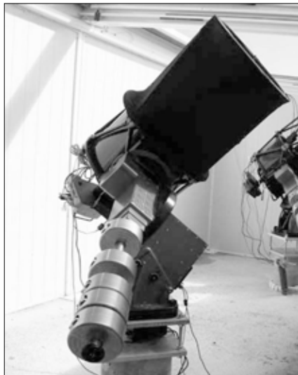
Az egyik legtöbbet „foglalkoztatott”, T7-es jelzésű, 430/2939-es, korrigált Dall-Kirkham távcső (Nerpio, Spanyolország)
