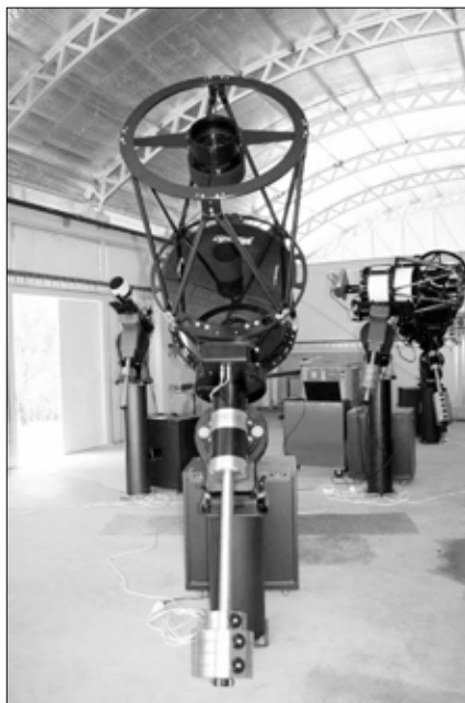
A Siding Spring-i Itelescope bázis letölthető tetejű észlelőházikója belülről, előtérben a T30-as, 510/2280-as korrigált Dall-Kirkham rendszerű távcsővel
