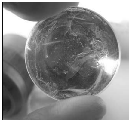
Napkivetítést megszenvedett ragasztott lencse. Napkivetítésnél ügyeljünk arra, hogy az okulár háza is fémből, és ne hőre lágyuló műanyagból készüljön
