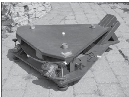
Alt-azimutból ekvatoriális! A platform órátengelye a jobb szélén látható, a két lapot összekötő rövid csomk. A mechanika órágeppel ellátott
