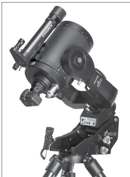
Villás mechanika. Figyeljük meg az órátengelyként működő villát, a deklinációs tengelyt a tubus és a villa csatlakozásainál, valamint az ellensúlyok hiányát. Az eredetileg alt-azimut mechanikát egy ekvatoriális ékkel „billenthetjük” a képen is látható helyzetbe
