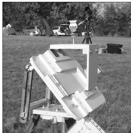
Újvárosy Antal továbbfejlesztett pajtaajtó-mechanikája. A rektaszenciós tengely a két lapot összefogó zsanérsor, amelynek pontos pólusraállását pólustávcső könnyíti meg. A mechanika órágéppel is ellátott!
