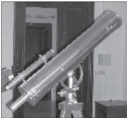
Gregory rendszerű tükrös távcső az egri Csillagászati Múzeumban. Az 1776-ban készült műszer élességállítását a segédtükrör mozgásával oldották meg
