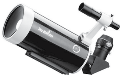
Makszutow-Cassegrain típusú távcső. Figyeljük meg a láthatóan erősen homorú felületű korrekciós lencsét!
