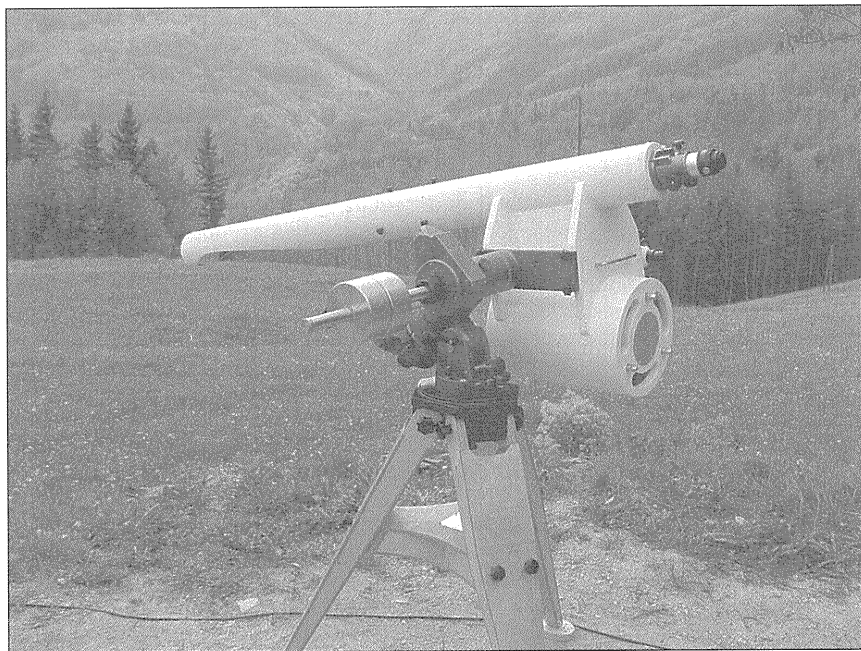
A cikkben említett ferdetűkrős rendszer (Kutter-távcső)
