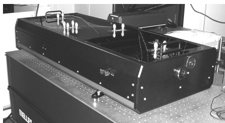
2. ábra • Az R&D Ultrafast Lasers Kft. FemtoRose 10 MCD csörpölt tükrökkel kompenzált, Kerr-lencsével módusszinkronizált Ti-zafir lézere
