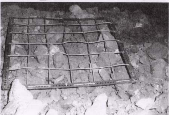
6. ábra: A lahócai kísérleti nagyrobbantás utáni szemcseszerkezet (a rács osztása: 15 cm)
