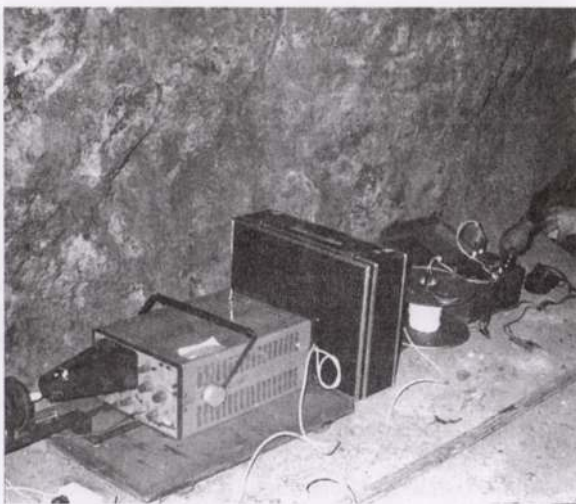
5. ábra: Mérő- és robbantóállomás a lahócai nagyrobbantásnál
