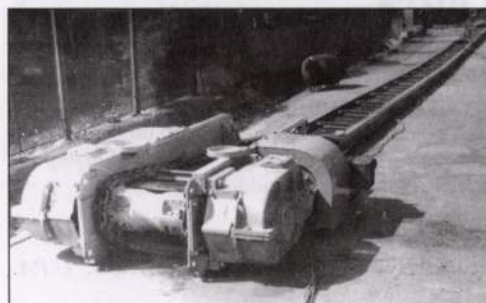
6. ábra. TR-2 típusú láncos vonszoló
