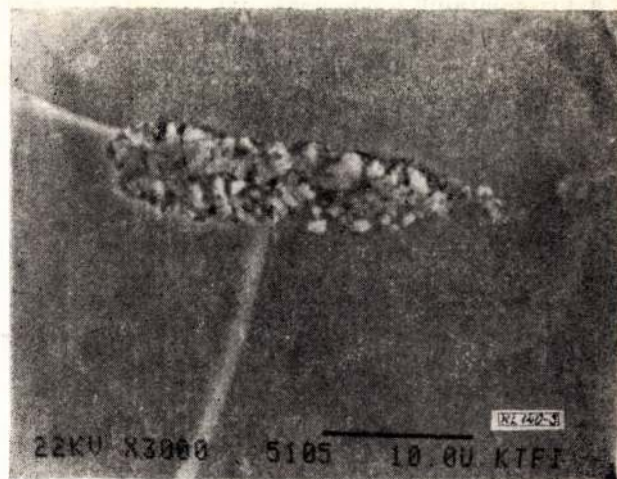
3. ábra. Összetett zárvány
