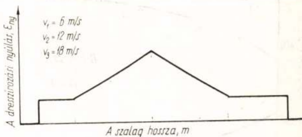
1. ábra. A dresszírozási nyúlás változása a teker- cs hossza mentén. A kísérleteket v_1 = 6 \text{ m/s} , v_2 = 12 \text{ m/s} és v_3 = 18 \text{ m/s} hengerlési sebességgel hajtottuk végre
