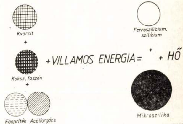
2. ábra. Szilícium és ferroszilícium gyártás elvi vázlata
