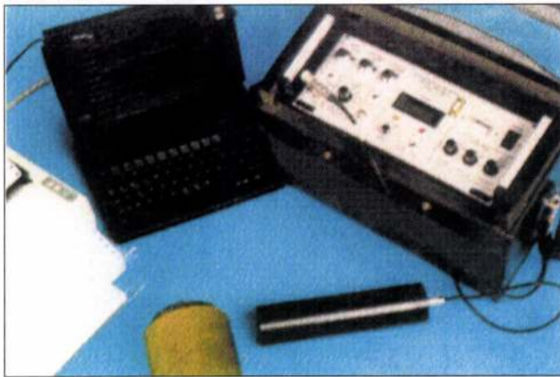
12. ábra. Természetes radioaktivitás- (gamma-) mérés a helyszínen
