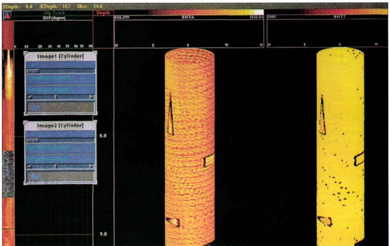
4. ábra. Preparált béléscső leképezése Fig. 4. CBIL response of the artificial failures
