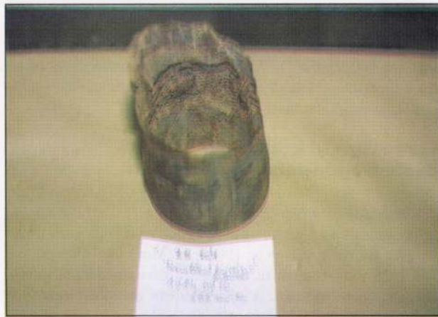
1. kép. Termelőcső-meghibásodás a B-III. sz. kútban
