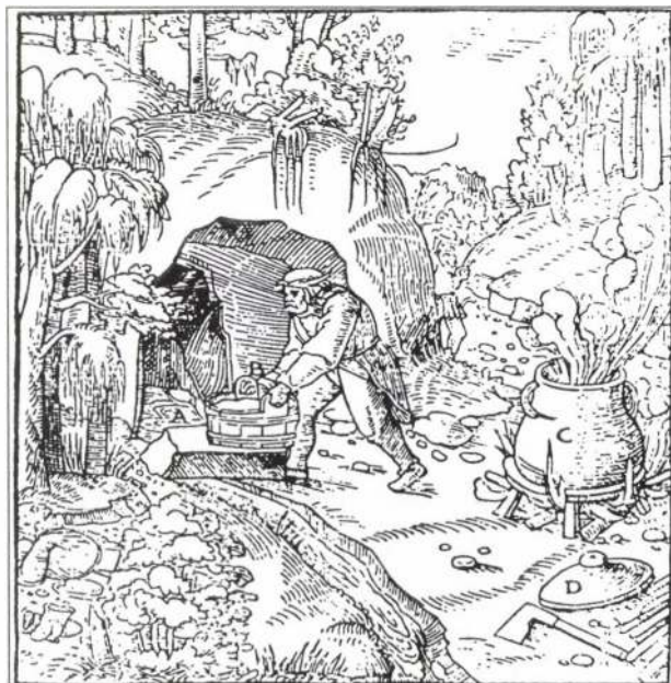
2. ábra. Bitumentermelés vízből, nyers bitumenből és kőzetből: B – sajtár; C – réz- és vasedény; D – réz- és vasedény fedele
