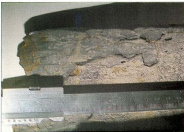
3. kép. Termelőcső-meghibásodás a Pf-90. sz. kútban
