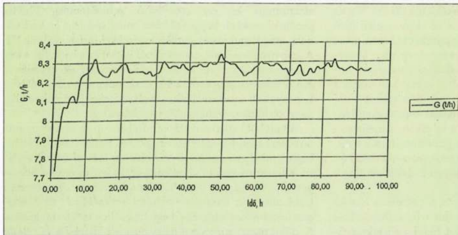
11. ábra. A gőztermelés változása az idő függvényében statikus elemek alkalmazásával Fig. 11. Steam production as a function of time with static mixers
