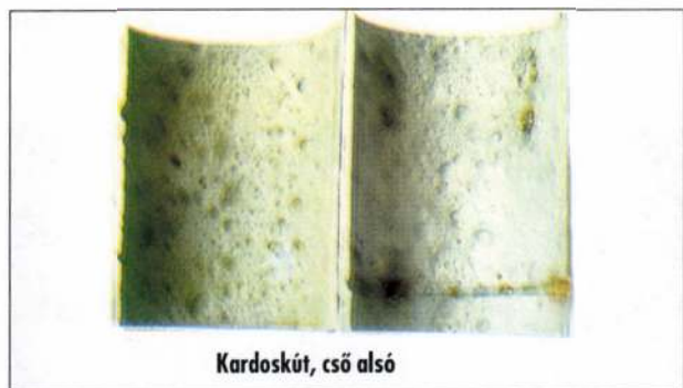
8. kép. A PFT-3 és PFT-7 vezeték meghibásodása
