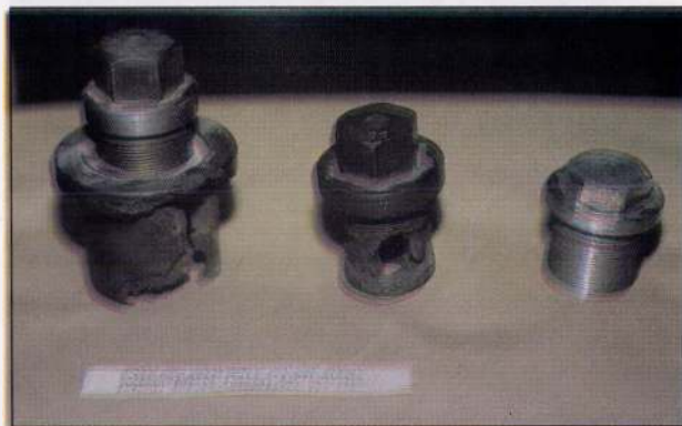
2. kép. Fúvókameghibásodás a B-III. sz. kútban
