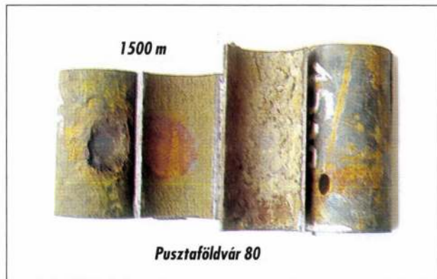
4. kép. Termelőcső-meghibásodás a Pf-90. sz. kútban
