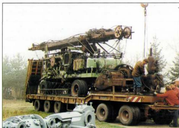
2. kép. Salzgitter PS-150 típusú berendezés és a G-16 típusú szivattyú a tréleren
