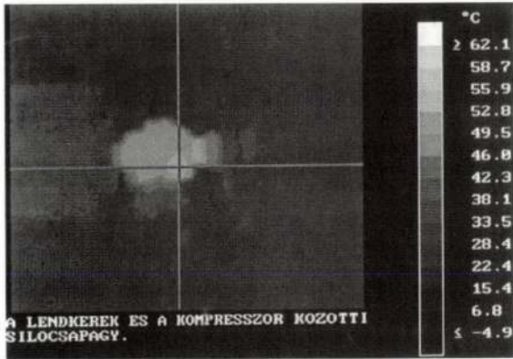
6. ábra. Egy silócsapágy termogramja
