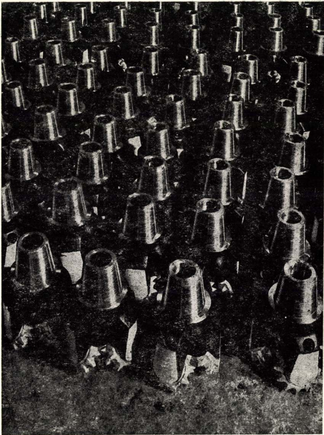
Görgősfűrök — a Dunántúli Kőolajipari Gépgyár termékét
