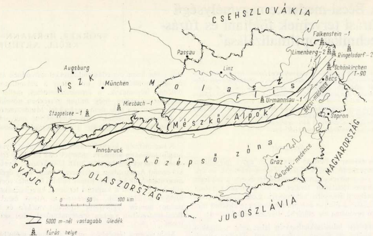
1. ábra A nagymélységű szénhidrogén-kutató fúrások lehetséges telepítési övei Ausztriában
