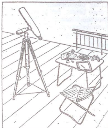
1. ábra. 80/420-as, háromlábú suállványon álló üstököskereső a szabadban felállítva
