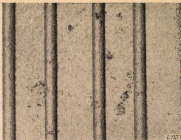
4. ábra. Egy öntvényfelület formázóanyagból és fekecsből származó hibái
