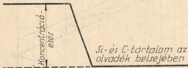
5. ábra. A koncentrációesés vázlata a karbonizálás és a szilíciozás közben
