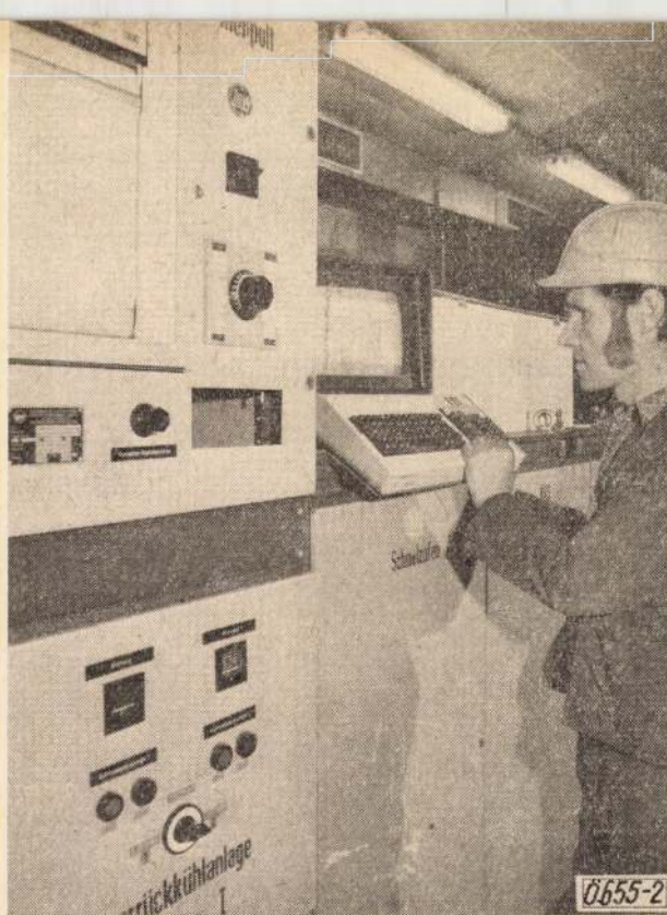
2. ábra. Mikroszámtógépes vezérlőegység egy fittingöntődob indukciós olvasztóművében
