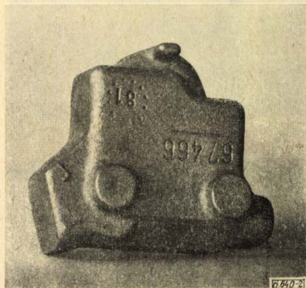
2. ábra. A Bosch blokkolásgátló rendszerének szelepfedele gömbrágitos Meehanite-öntöttvasból
