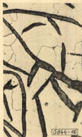
16. ábra. A 45 jelű lemezgrafitos öntöttvas szövete, 2 °C/perc hűtési sebesség után
