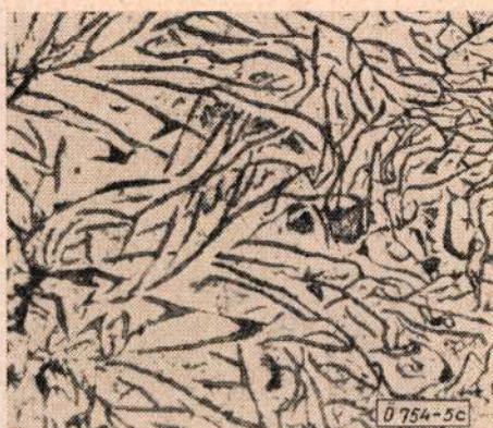
5. ábra. 1,2% VL 53/S segédötvozzel kezelt öntöttvas mikroszkópi szövetképe. a-2 perc; b-7 perc; c-12 perc; d-17 perc hőtartás után öntve. 2%-os HNO 3 -ban maratva, N = 100 ×
