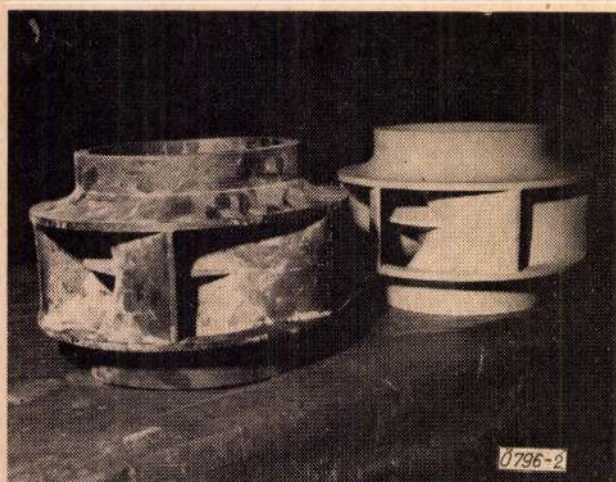
2. ábra. A viaszminta és az acélöntvény
