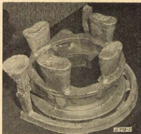
5. ábra. \text{öAlCu4MgTi} ötvözetből öntött nagy szilárdságú öntvény a beömlőrendszerrel és a tápfejekkel
