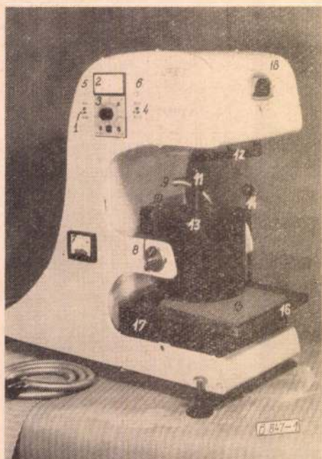
1. ábra. CASTMATIC-B típusú folyékonyságvizsgáló berendezés: 1 — főkapcsoló (ki-be), 2 — hőmérsékletmérő műszer, 3 — hőmérsékletszabályozó műszer, 4 — kapcsoló (kézi-automata), 5-6 — jelzőlámpák, 7 — ampermérő műszer, 8 — rögzítő anya, 9 — gégecsőben táp- és kompenzációs vezeték, 10 — hőelem, 11 — grafitdugó, 12 — grafitdugót emelő kar, 13 — kemencetest, 14 — tartólapot emelő kar, 15 — forma, 16 — tepszi azbesztlappal, 17 — rugókkal feszített tartólap
