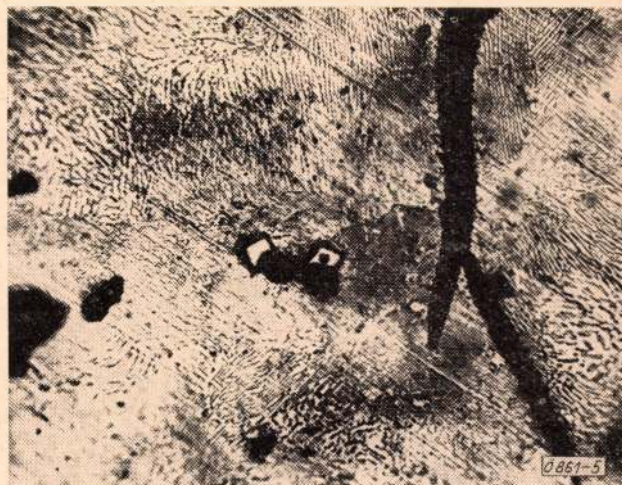
5. ábra. A csiszolaton mikroszkóppal alig észrevehető apró zárványok az öntöttvasban. A világos zárványok títán-karbid-nitridek, míg a sötétek mangán-oxid-szulfidok. 1200×2×
