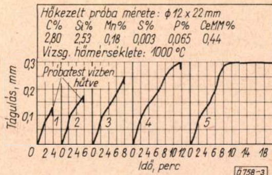
3. ábra. A grafitosodás követése dilatációs görbéken
