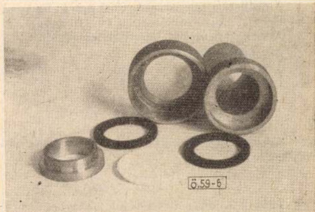
6. ábra. A befogóberendezés szétszedett állapotban
