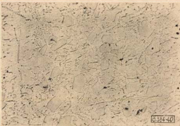
40. ábra. Vörös foszforral és fémtitánnal végzett nemesítés után 60 perccel vett minta szövete képe, N = 150 \times
