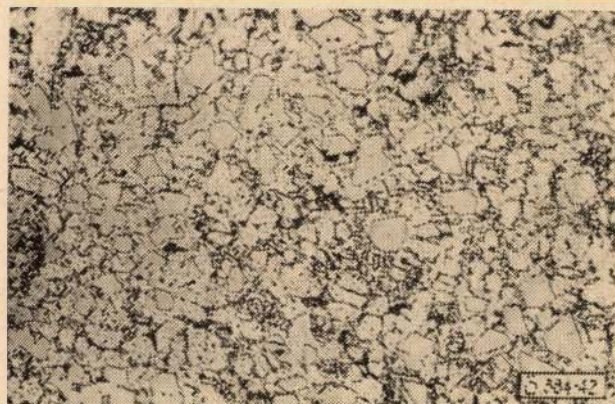
42. ábra. Foszforral, titánnal és bórral együttesen nemesített ötvözet szövete képe, N = 150 \times
