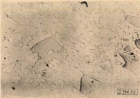
29. ábra. Az üzemi kísérletek nemesítetlen ötvözetének szövete képe, N = 150 \times
