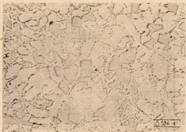
41. ábra. Vörös foszforral és fémtitánnal végzett nemesítés után 120 perccel vett minta szövete képe, N = 150 \times
