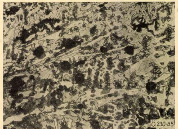
35. ábra. 193/2-jelű próbatest öntött szövetképe (300×, 3% alk. HNO_3 ) (2/3)
