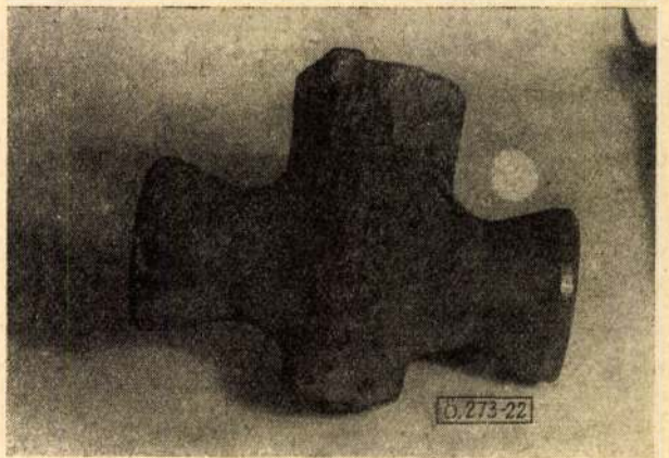
22. ábra. Gázos, de odvasodási üreg nélküli csapház
