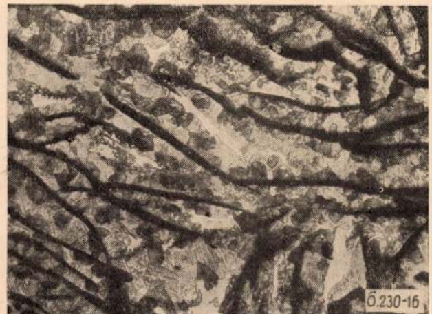
16. ábra. 189/2-jelű próbatest öntött szövetképe izzítás után (300 ×) (2/3)
