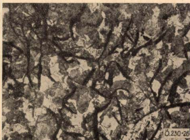
26. ábra. 190/1-jelű próbatest szövete képe, izzítás után, kemencében hűlt ( 300\times , 3% alk. HNO_3 ) (2/3)
