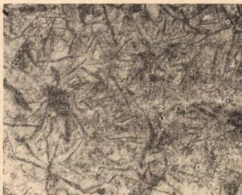
18. ábra Hipereutektikus S_c = 1,22 100-szoros nagyítás, maratva 2%-os alkoholos HNO_3 -mal
