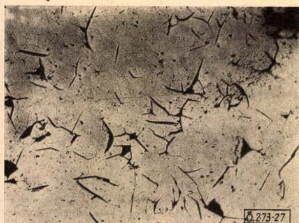
27. ábra. A 153. sz. adag szövete képe maratlan állapotban. Eutektikus jelleg, kevés hipereutektikus szövetrel. N = 100 ×.
