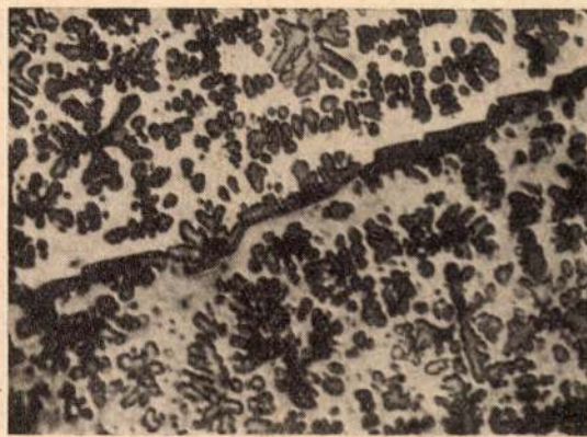
8. ábra. Túltelített szekundér \beta + \xi + \gamma szerkezet. N = 400 \times Elektrolitikusan maratva
