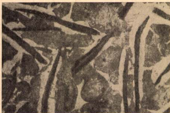
1. ábra. Lemezes grafitos kokilla anyag mikroképe [4] 200 ×
