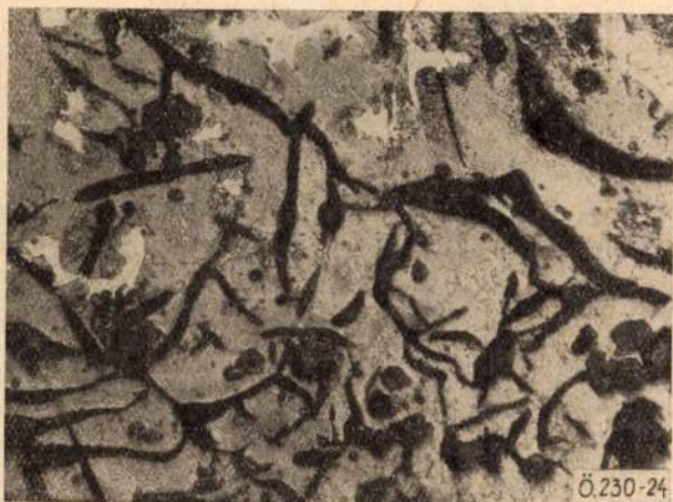
24. ábra. 189/2-jelű próbatest szövete képe, 8 órás izzítás után, olajban hűlt ( 300\times , 3% alk. HNO_3 ) (2/3)
