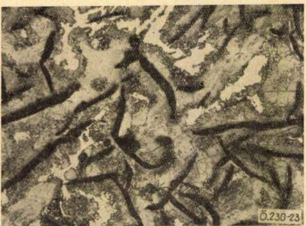
23. ábra. 189/2-jelű próbatest szövete képe, 8 óras izzítás után, levegőn hűlt (300×, 3% alk. HNO 3 ) (2/3)
