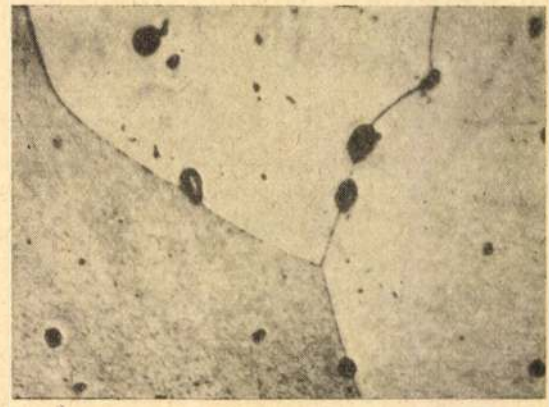
4. ábra. Túltelített \beta -szilárdoldat szerkezete. N = 400 × Elektrolitikusan maratva
