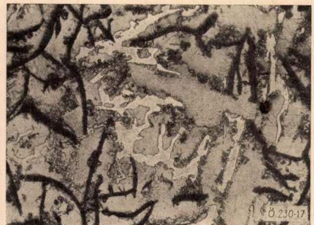
17. ábra. 189/2-jelű próbatest szövetképe 2 órás izzítás után, levegőn hűlt (300 ×, 3% alk. HNO 3 ) (2/3)
