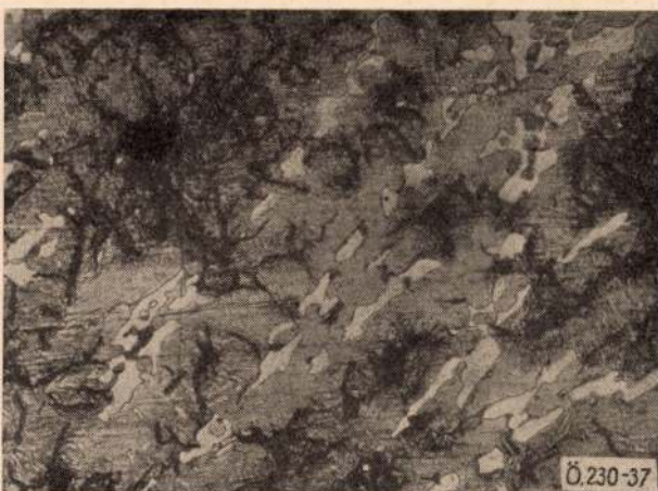
37. ábra. Lemezes grafitú öntöttvas szövetképe, 72 órás izzítás után (300 \times , 3% alk. HNO_3 ) (2/3)
