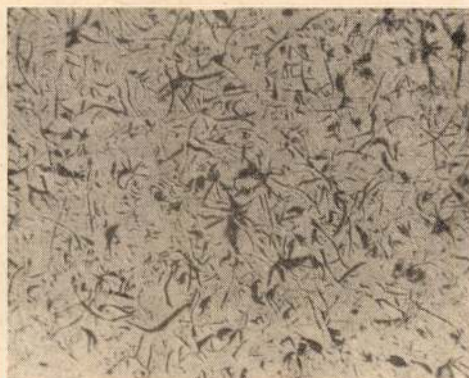
15. ábra Hipereutektikus S_c = 1,22 50-szeres nagyítás, marallan
