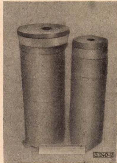
12. ábra. Albr 10 hüvely állva öntve, a tápfejek porral melegítve
