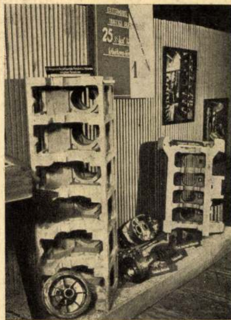
3. ábra. Különböző technológiával készült könnyűfém-öntvények a kiállításon. Előtérben a teljesen magformában készült 6 hengeres forgattyúház felsőrészének öntvények, középen kokillában és présöntéssel készült alumínium alkatrészek láthatók
