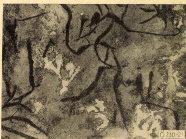
21. ábra. 189/2-jelű próbatest szövete képe, 4 óras izzítás után, olajban hűlt (300×, 3% alk. HNO 3 ) (2/3)
