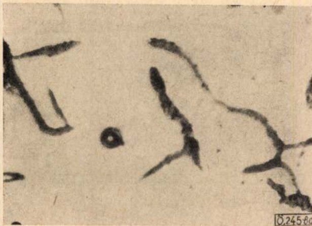
8/a ábra. Szilikátcsépp a 17. próbában (N = 1000×, maratlan fehér fény)
