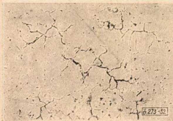
32. ábra. A 28. ábrán közölt öntött állapotú ferroszil (850 C°-on 8 órán át hőkezelve) darabjának szövetképe maratlan állapotban. Grafit dúsulás. N = 100 ×
