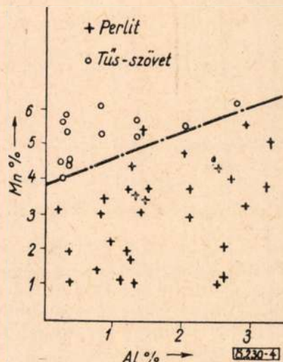
3. ábra. A Mn- és Al-tól függő szövet a T sorozatban
