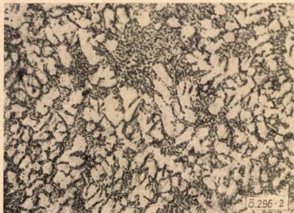
2. ábra. 20 órán át 200 C°-on öregbített levegőn hűlt dugattyú szövete
