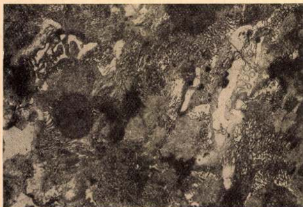
3. ábra. Rövid időtartammal hőkezelt hazai kokilla éktuskó szövetképe (6) 300 ×
