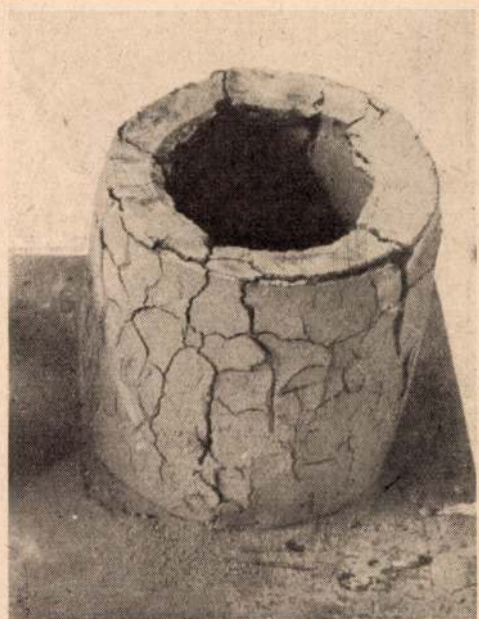
12. ábra. Összerepedezett tápfejtető
