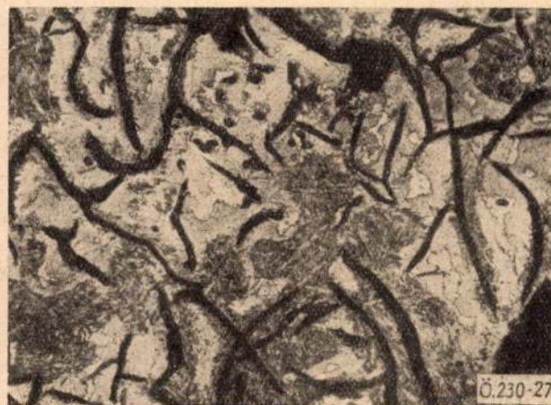
27. ábra. 190/1-jelű próbatest szövete képe, izzítás után, olajban hűlt ( 300\times , 3% alk. HNO_3 ) (2/3)
