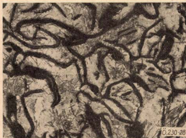
28. ábra. 190/2-jelű próbatest öntött szövete képe ( 300\times , 3% alk. HNO_3 ) (2/3)
