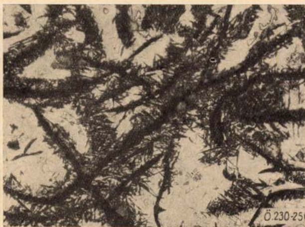
25. ábra. 190/1-jelű próbatest öntött szövete képe ( 300\times , 3% alk. HNO_3 ) (2/3)
