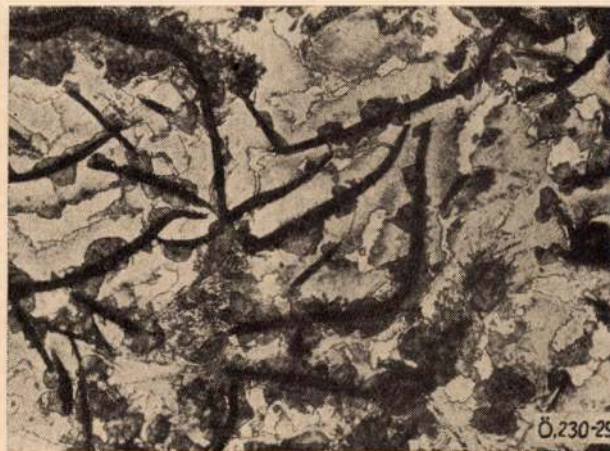
29. ábra. 190/2-jelű próbatest szövete képe izzítás után, kemencében hűlt ( 300\times , 3% alk. HNO_3 ) (2/3)
