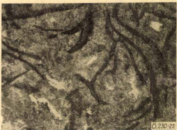
22. ábra. 189/2-jelű próbatest szövete képe, 8 óras izzítás után, kemencében hűlt (300×, 3% alk. HNO 3 ) (2/3)
