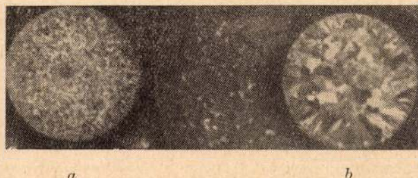
4. ábra. Magnezittörmeléken szűrve a szövet durvulása nem lépi túl a megengedhető határt, a) szennyezett, b) magneziten szűrt próbatetek szöve
