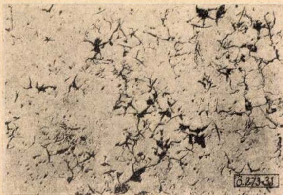
31. ábra. A 27. ábrán közölt öntött állapotú ferroszil (850 C°-on 8 órán át hőkezelve) darabjának szövetképe maratlan állapotban. Grafit dúsulás. N = 100 ×
