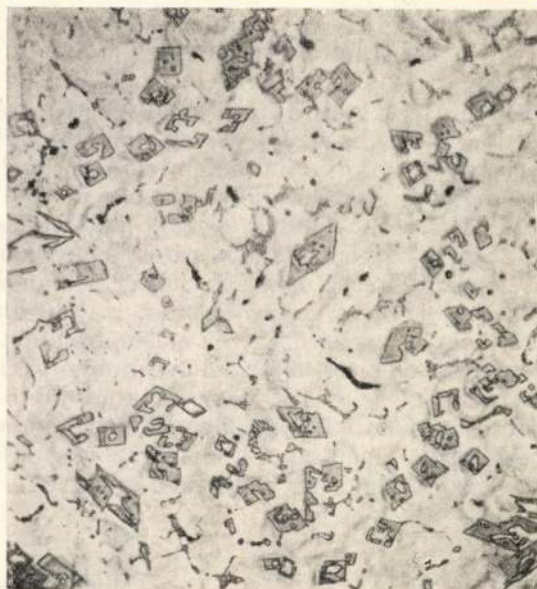
2. ábra. Mangánnal történő ötvözés után kialakult Al-Mn-Fe három alkotós vegyület kristallitjai. 150 ×
