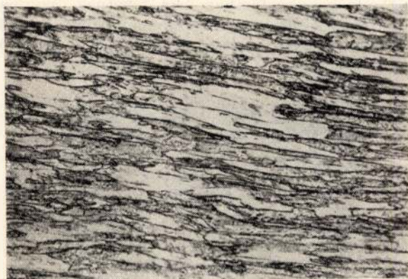
2. ábra. Kovácsolt, 2,2 mm \varnothing -jű volfrámrúd (N = 150 x)
