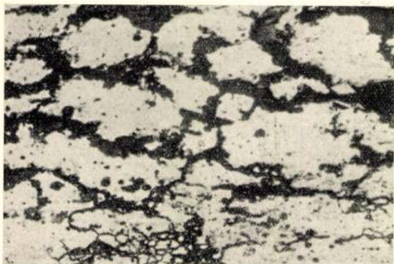
13. ábra. Homogenizálás után 150° C-on 24 órán át öregített Al-Mg 7 lemez kristályközi korróziója.
