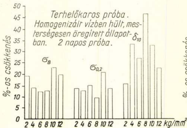
10. ábra. Al-Mg 5 lemezek szilárdsági tulajdonságainak százalékos csökkenése különböző kísérleti feszültség mellett.
