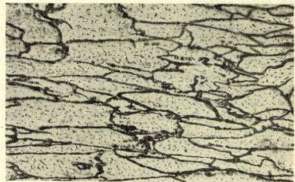
27. ábra. Porlasztással készített alumíniumpor (100×).
