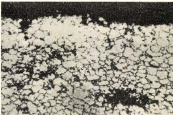
2. ábra. Kristályközi korrózió; az 1. ábrabeli próbatest másik részlete.
