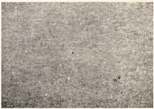
8. ábra. Eloxált alumíniumlemez 98 napig alkoholban korrodáltatva.
