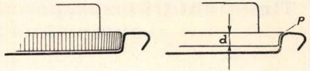
8. ábra. Fehérbádóg konzervdoboz zárásánál használatos zárófejlap, sűrű függőleges recézéssel. Ujformájú zárófejlap, melynek felső széle peremes kialakítású „d” és csak olyan vastag „d”, hogy nem ér a dobozfedélig.
