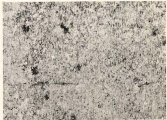
6. ábra. Szórópisztolyos eljárással kezelt alumíniumlemez 98 napig alkoholban korrodáltatva (hideg lemezre szórt meleg oxidációs szer).
