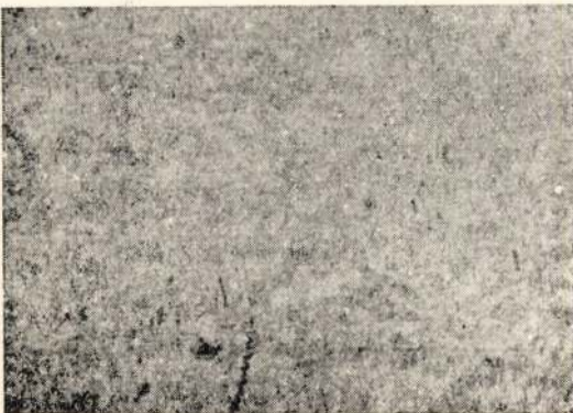
7. ábra. Szórópisztolyos oxidációs eljárással kezelt alumíniumlemez 98 napig alkoholban korrodáltatva (meleg lemezre szórt meleg oxidációs szer).
