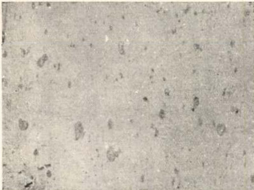
3. ábra. 99.6% tisztaságú lágy alumíniumlemez 98 napig alkoholban korrodáltatva.
