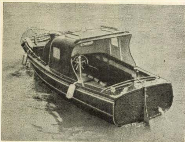
5. ábra. Korrozióálló alumínium-ötvözetből készült motóresónak.
