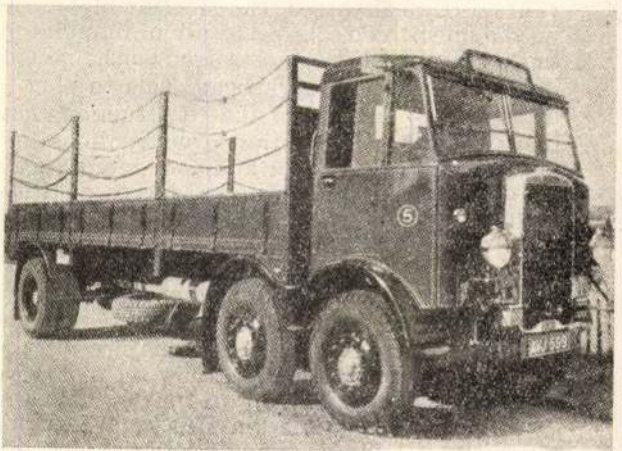
2. ábra. Szegecselte könnyűfémprofilokból készült alváz és könnyűfém felépítmény.
