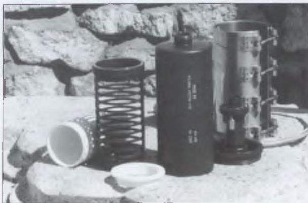
10. ábra. A nagytérfogatú mérőkör szűrőháza szét-szedett állapotban (zsákszűrő, szűrőtartó, szűrőház és szűrőház fűtés)
