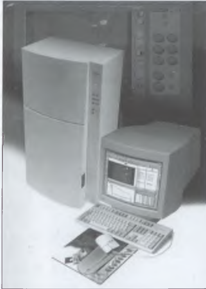
4. ábra. A Syngene cég GeneGenius típus géldokumentációs és elemző rendszere
