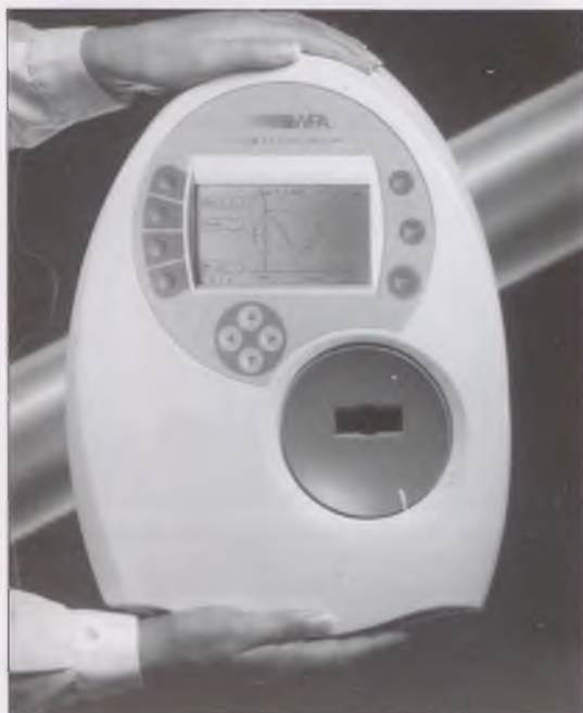
3. ábra. A WPA cég S2000 típusú, Lightwave spektrofotométere
