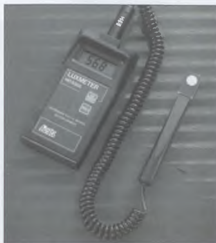
2. ábra. A Delta OMH cég HC 8366 típusú megvilágításmérője
