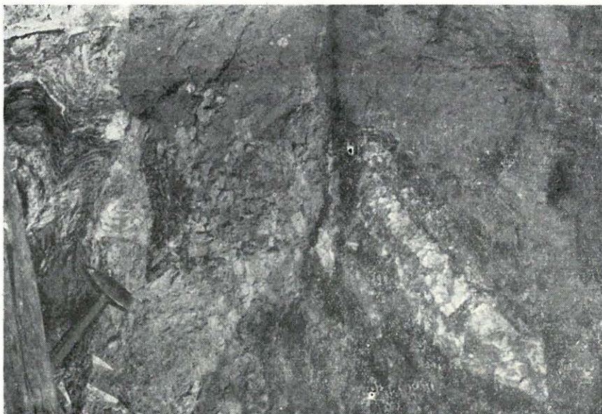
27. ábra. Elvonszolt ércszegély pátvasérc és vöröscsíkos kampili agyagmárga tektonikus érintkezésén. — X-es É, szállítóvágat.
