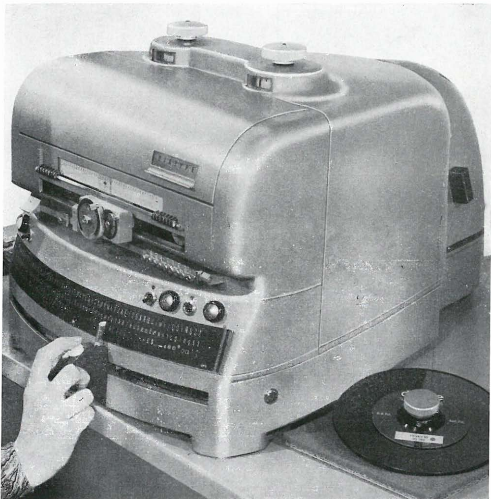
Fig. 5. Machine à photocomposer les textes horscadre des cartes géologiques
