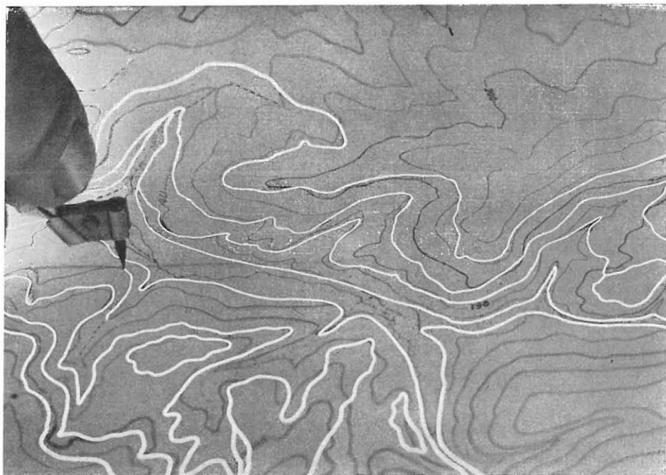
Fig. 4. Le procédé du tracé sur couche employé pour le dessin des contours géologiques
