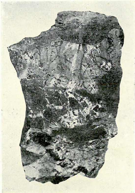
11. ábra. K. 26. sz. fúrás, 764,94—766,09 m. Trachidoleriterek a palásagyagban. — Bohrung No. K. 26, 764,94—766,09 m. Trachydoleritadern im Schieferthon. (Photo: Dömök T.)
