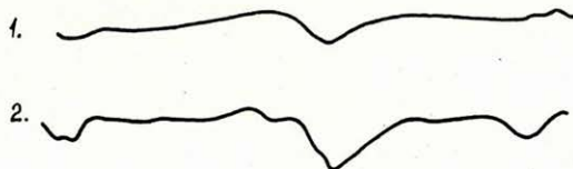
8. ábra. Alsó-liász kőszéntelepes összletből vett kemény palásagyag differenciális termikus vizsgálata. (Áll. Földtani Intézet kémiai laboratóriuma, KOBLENZ V.)
