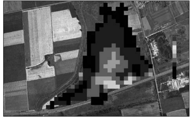
1.sz. mértékadó szakadási helyen az elöntés képe a szakadás után 7,5 órával, Kál mellett – az M3-as autópályán kezd átbukni a víz
