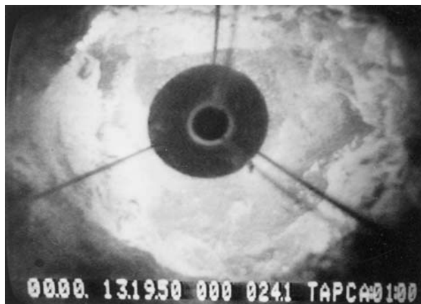
4. kép. Lyuktelevíziós vizsgálat Tapolca MÁV állomáson
