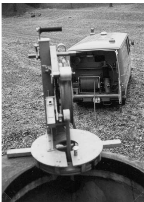
2. kép. IBAK rendszerű ipari televízió vertikális csörlővel
