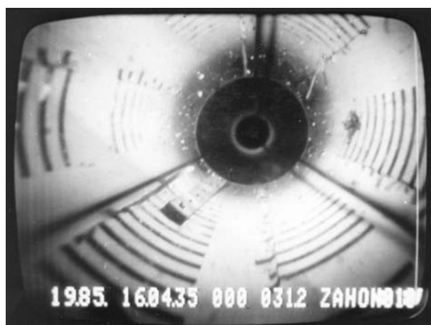
5. kép. Idegen tárgy kimutatása Záhony MÁV állomás V. kútjában
