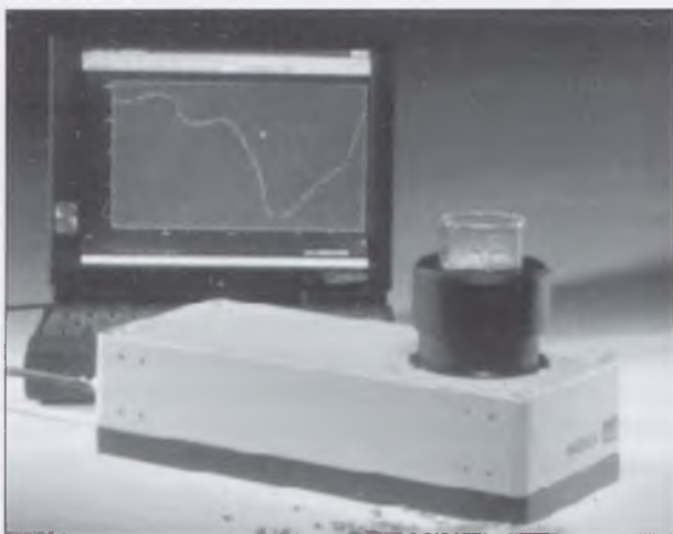
4. ábra. A Carl Zeiss Jena cég CORONA típusú univerzális optikai spektrális érzékelő egysége
