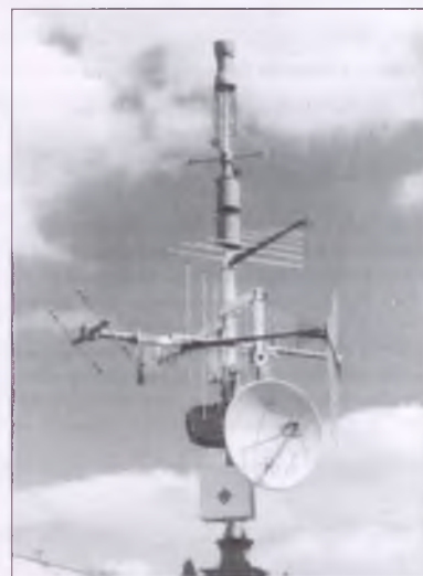
3. ábra. Térmérő antennarendszer
