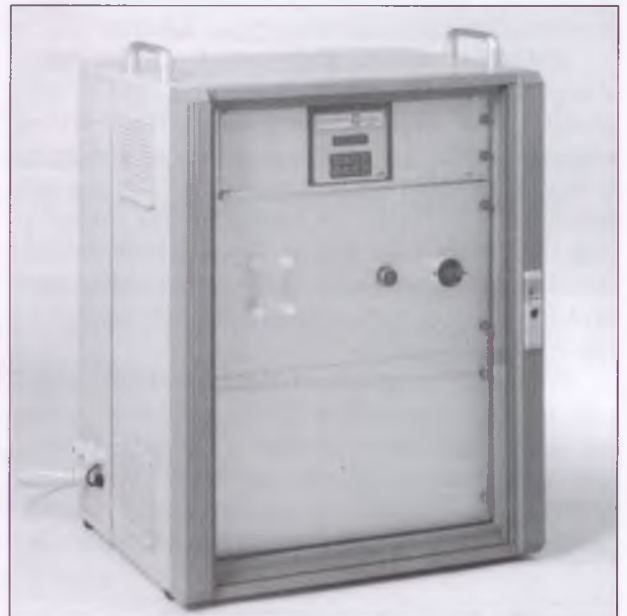
3. ábra. Dr. Födisch Umwelttechnik cég OMD 1.10 típusú folyamatos szagmérő műszere
