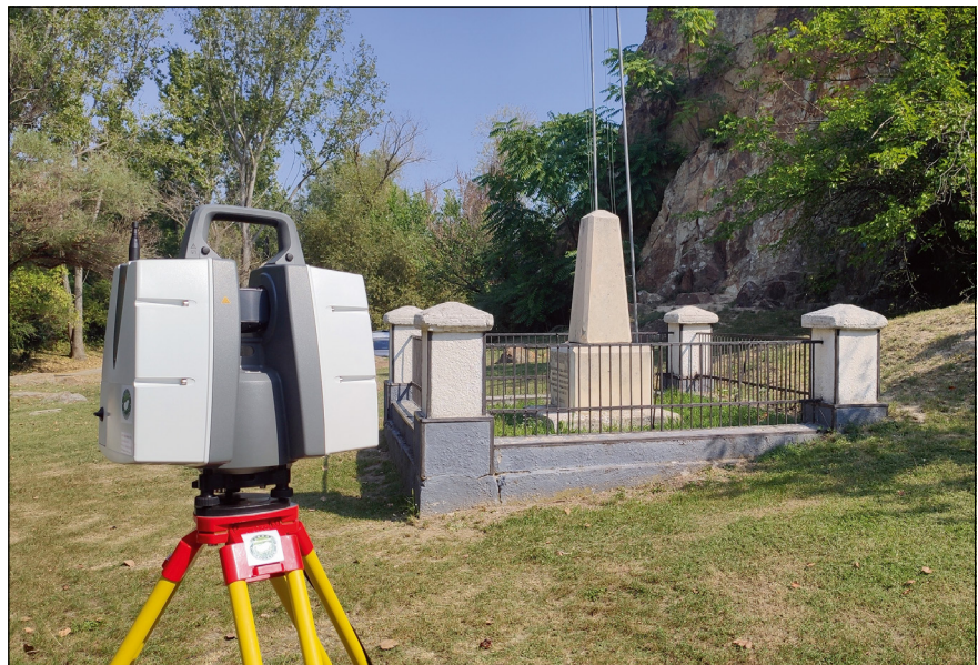
2. ábra. Leica P40 lézerszkennner az obeliszke előterében
